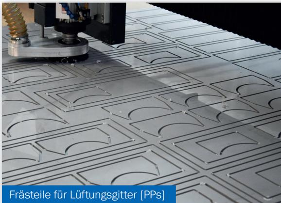
Frästeile für Lüftungsgitter [PPs]
